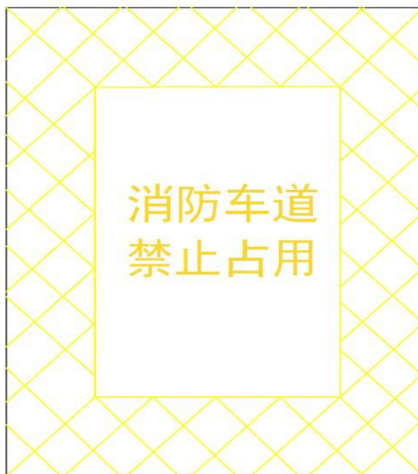
图 2：消防车通道出入口禁停标线及路面警示标志示例
